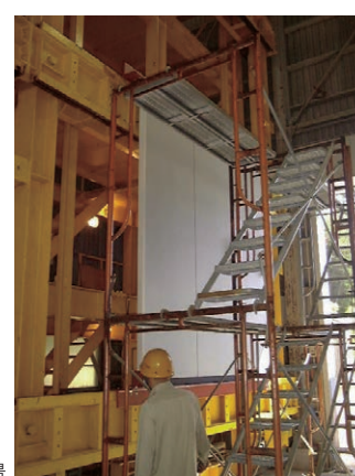
層間変位試験風景
